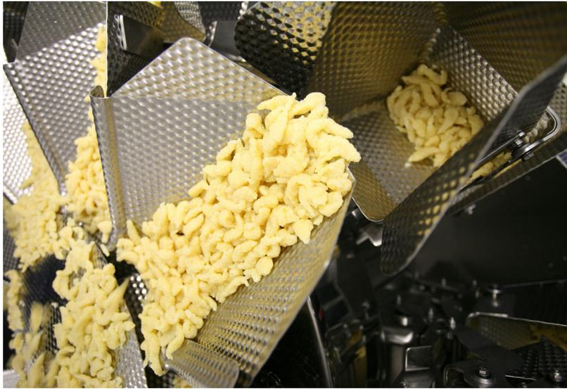
Die Eierspätzle werden durch vibrierende Radialrinnen zu den Schalen befördert, die Mehrkopfwaage füllt die präzise dosierten Produktportionen direkt in Schlauchbeutel ab. Bild: Ishida
