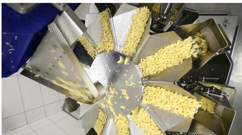
Die frischen Teigwaren gelangen von oben auf den Verteilteller der Waage. Bild: Ishida
