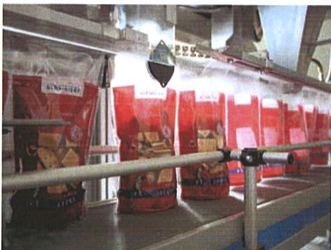
Die Hundekekse werden durch einen Senktrichter in Standbodenbeutel abgefüllt
