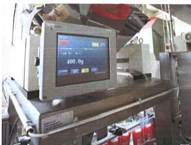
Die Mehrkopfwaaage sorgt für Genauigkeit bei der Abfüllung der Hundekekse
