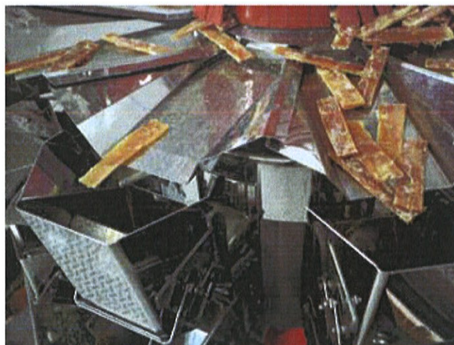
Die Mehrkopfwaage Ishida CCW-RS hält die sperrigen Produkte optimal im Fluss
