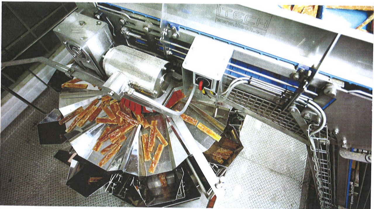
Die neue Verpackungslinie für Kautsticks reduzierte den Produktverlust drastisch. Von oben gelangen die Kautsticks auf die Mehrkopfwaage.
