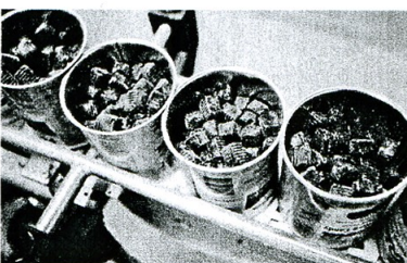
Die befüllten Dosen auf dem Auslauf der Abfüllanlage
